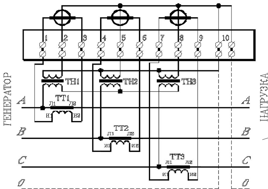
**ВАЖНО!** В соответствии с "Правилами устройства электроустановок" (ПУЭ п. 1.5.23) все трехфазные счетчики трансформаторного включения необходимо подключать через коробку испытательную переходную. Коробка должна обеспечивать закорачивание вторичных цепей внешних измерительных трансформаторов тока, отключение фазных токовых цепей и цепей напряжения счетчика при его замене, а также включение эталонного счетчика для поверки без отключения нагрузки (потребителя).
