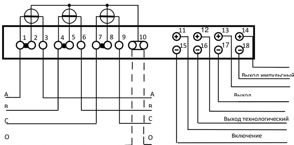
Типовая схема подключения трехфазного электросчетчика с помощью трех трансформаторов тока к трехфазной 3-х или 4-х проводной сети
