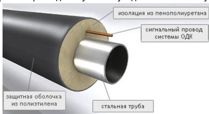
Рисунок 15. Составляющие трубы предизолированной
